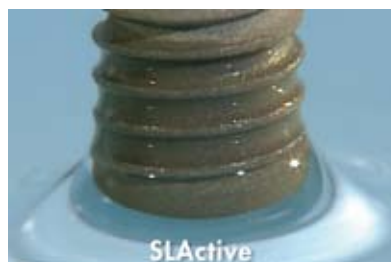
Fig. 3: La inmersión en agua de los implantes SLA y SLActive demuestra que el agua "moja" la superficie SLActive y que hay un menisco cóncavo en la interfase agua-aire-implante.
