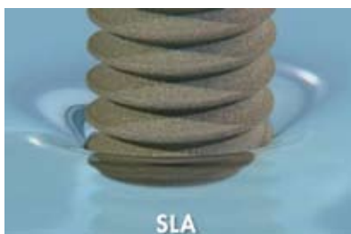
Fig. 3: La inmersión en agua de los implantes SLA y SLActive demuestra que el agua "moja" la superficie SLActive y que hay un menisco cóncavo en la interfase agua-aire-implante.
